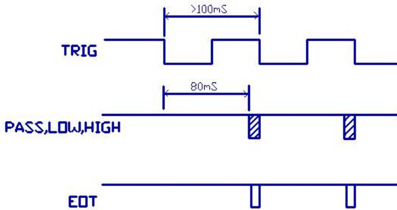
触发信号（EXT. TRIG）为下降沿低电平触发，而 EOT 为高电平时为测试周期。利用 Handler 接口信号可用于自动测试。
