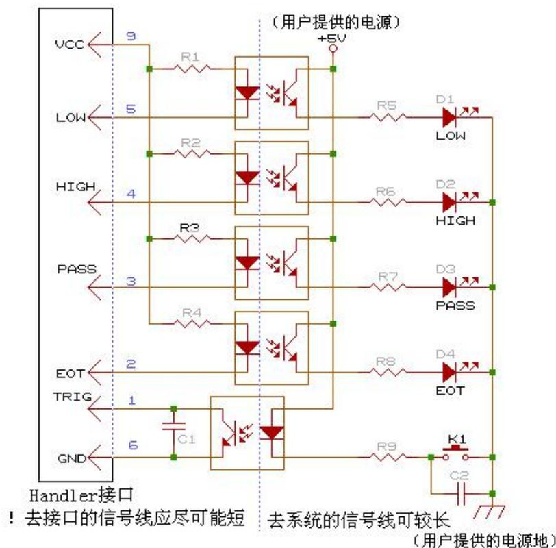
将仪器 Handler 模拟电路接到仪器的 Handler 接口，并设定仪器的分选中心值及上，
