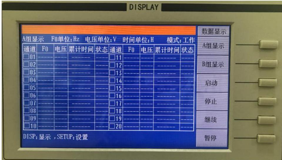
在此界面【F3】启动键，启动测试；此时界面会显示已选择通道的测试数据；
