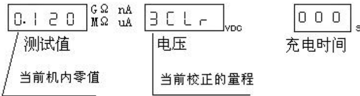
图 3-2 正在清零校准，测试值显示器显示当前量程的零值（mV）
